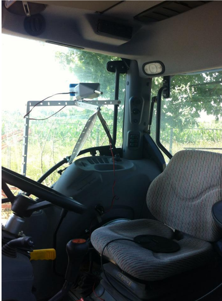
Slika 5. Položaj uređaja u odnosu na referentnu točku sjedala rukovatelja (Izvor: vlastita fotografija)
