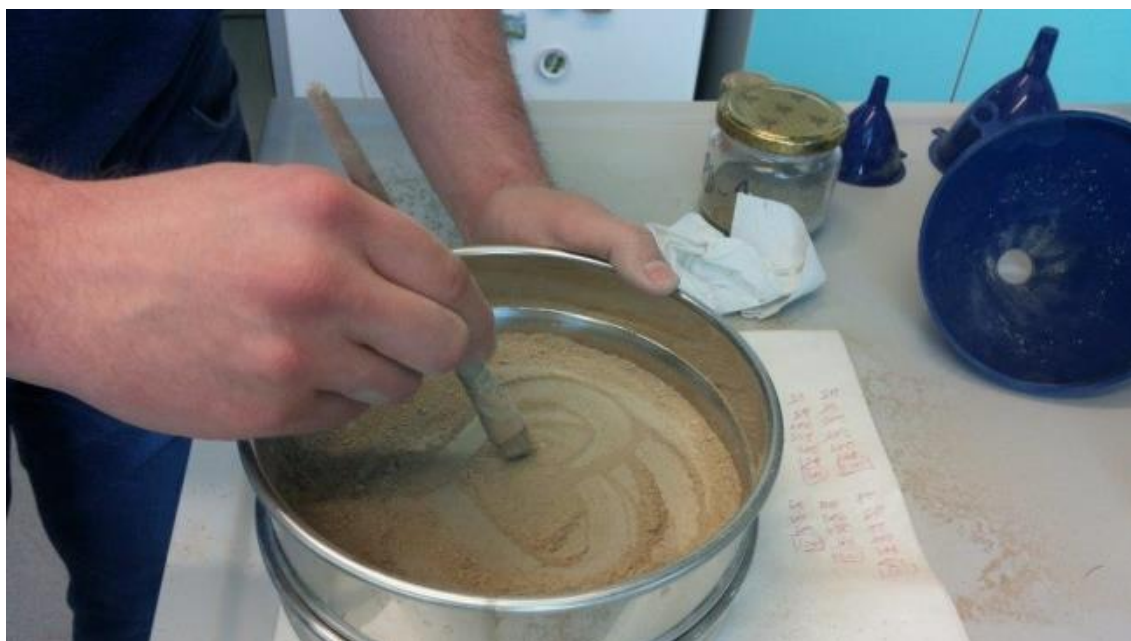
Slika 12. Prosijavanje prašiva (Izvor: Lucić, P.)
