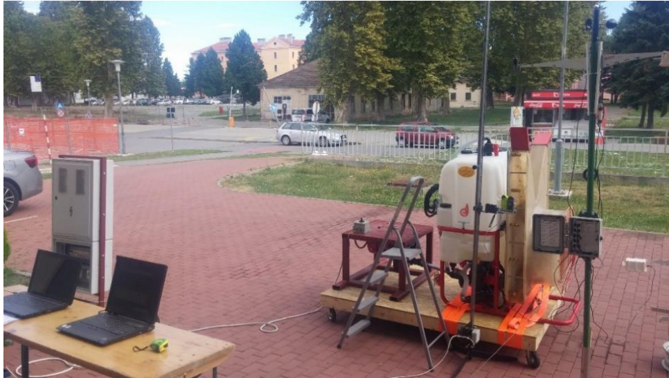
Slika 15. Mjerenje vertikalne raspodjele zraka anemometrom Kestrel 4500 BT Autor: D. Petrović
