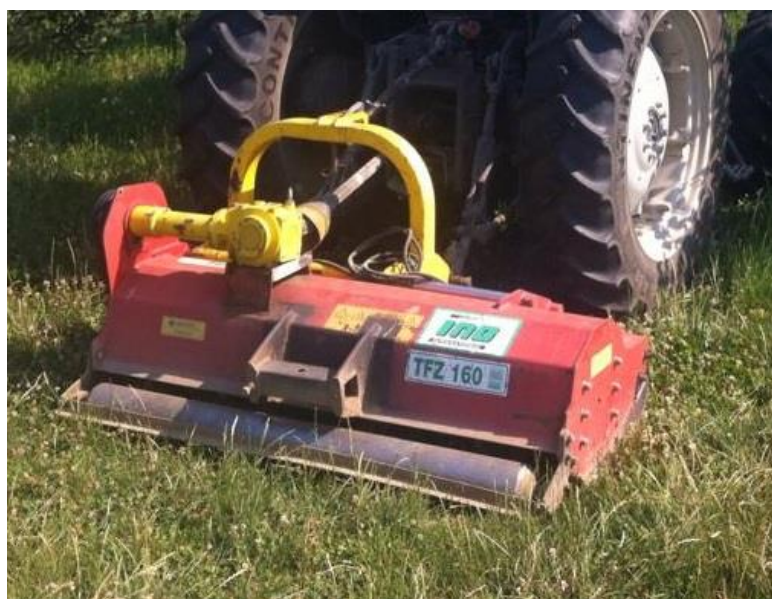
Slika 8. Malčer VOGER model TFZ 160 (vlastita fotografija)
