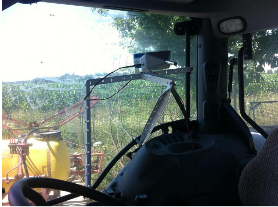
Slika 3. Postavljanje uređaja za mjerenje buke (vlastita fotografija)
