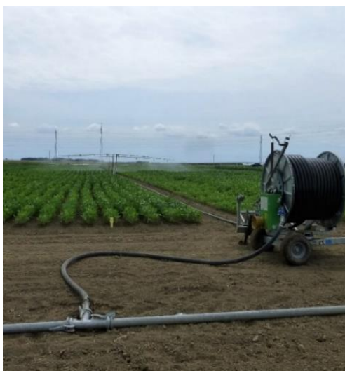
Slika 3. Navodnjavanje parcela samohodnim rasprskivačem s kišnim krilom (foto original; D. Galić Subašić)
