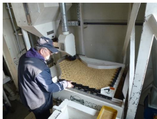
Slika 15. Gravitacijski stol (foto original; D. Galić Subašić)
