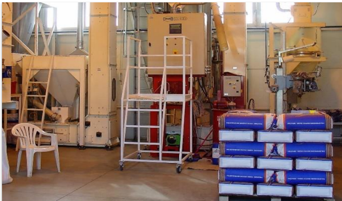
Slika 16. Zprašivač, linija za vaganje i pakiranje dorađene soje (foto original; D. Galić Subašić)
