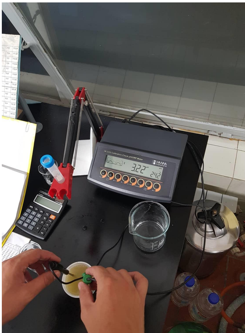
Slika 12. Postupak određivanja pH pomoću pH metra (Izvor: Čopčić, T., 2018.)
