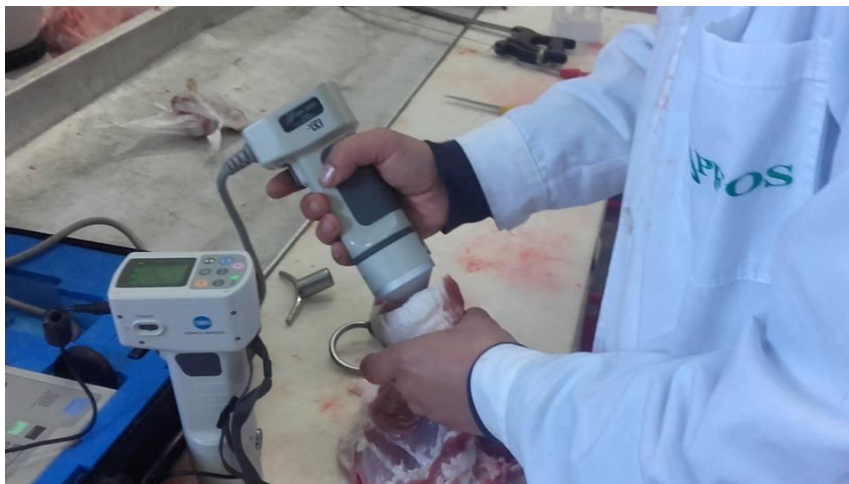
Slika 13. Određivanje boje mesa pomoću Minolta kolorimetra (Izvor: Arhiva Katedre za animalne proizvode, Fakultet Agrobiotehničkih znanosti Osijek)
