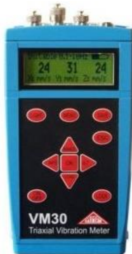
Slika 9. Uređaj za mjerenje vibracija MMF VM30
