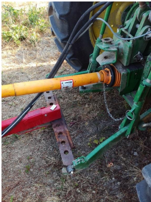
Slika 4. Način agregatiranja stroja (Vlastiti izvor)
