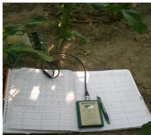
Slika 10. Očitavanje vrijednosti *Watermark* uređajem
