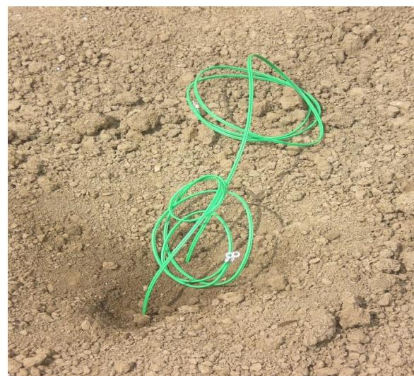
Slika 12. Senzori ukopani u tlo sa elektrodama na površini tla
