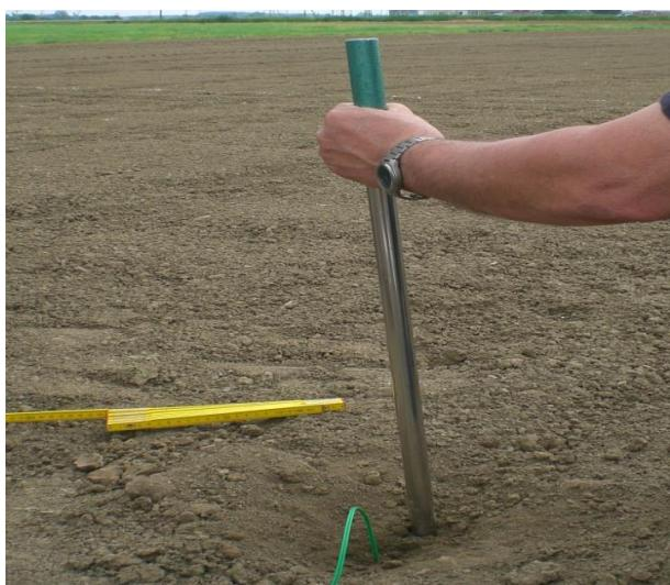
Slika 11. Bušenje otvora za postavljanje *Watermark* senzora
