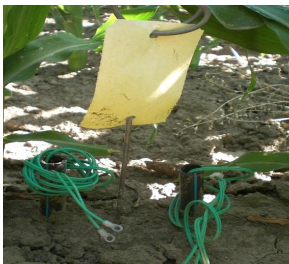
Slika 9. Elektrode *Watermark* senzora
