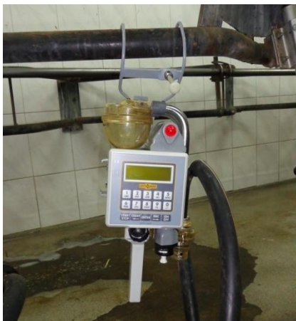
Slika 1. Mjerni uređaj Lacto-corder
