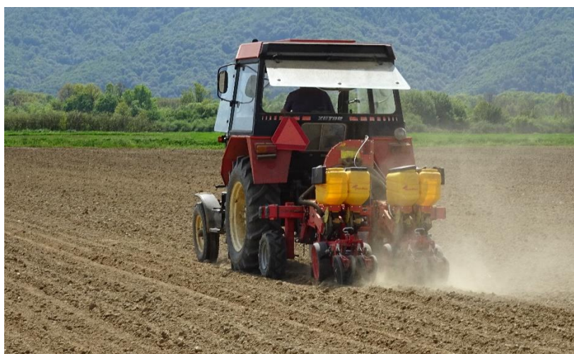
Slika 12. Sjetva kukuruza sijačicom Matermacc (Izvor: foto original F. Polak)
