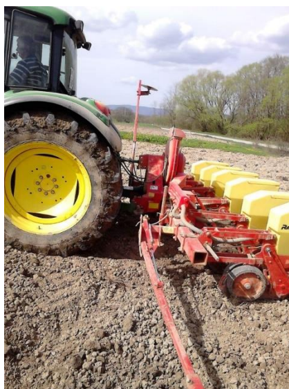
Slika 8. Pneumatska sijačica RAU MAXEM MX8P (Izvor: foto original F. Polak)
