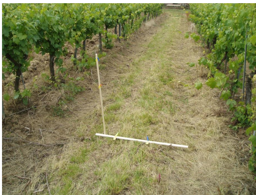
Slika 28. Mjerenje zanošenja sa vodoosjetljivim papirićima
