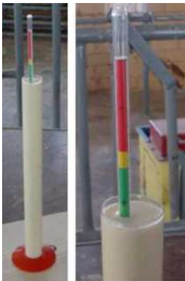
Slika 7. Kolostrometar pluta u uzorku kolostruma
