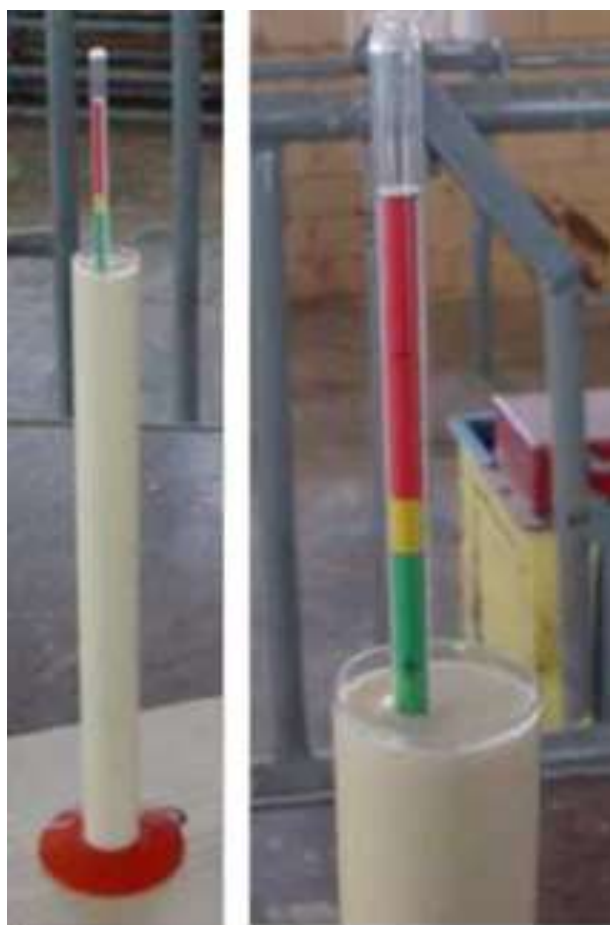
Slika 7. Kolostrometar pluta u uzorku kolostruma
