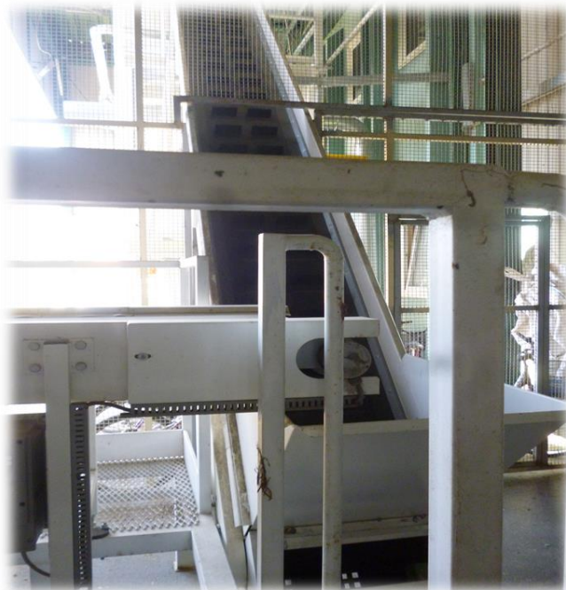
Slika 13. Transportna traka za transport klipa ka runjaču (Izvor: vlastita fotografija)
