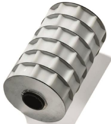
Slika 51. Dozirni valjak volumena 210 cm 3
