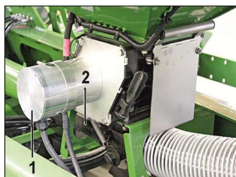
Slika 55. Prikaz elektromotora (1) i komore dozirnog valjka (2)
