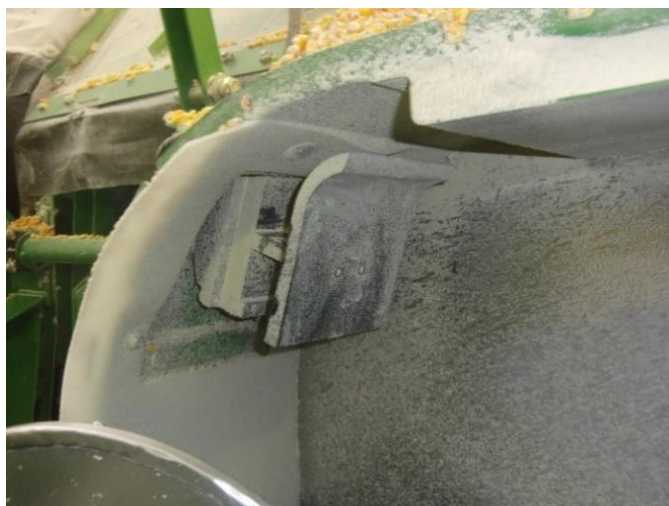
Slika 69. Senzor udara – protoka mase u eksploatacijskim uvjetima
