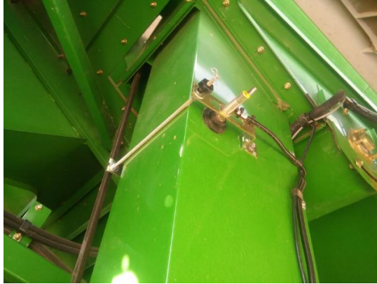
Slika 71. Naknadno postavljeni sustav mjerenja obujma zrna i fotosenzori sustava (desno)
