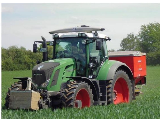
Slika 40. Yara dušični senzori postavljeni na kabinu traktora
