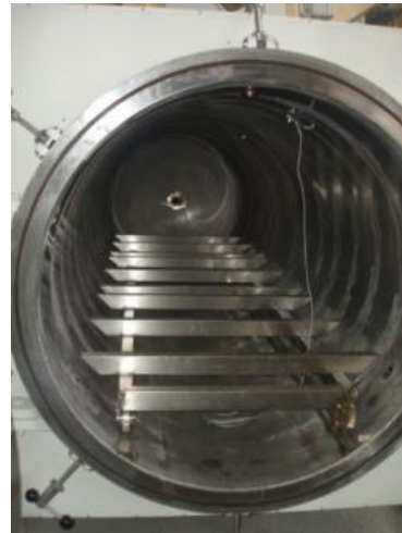
Slika 6. Prikaz cjevastog oblika komore
