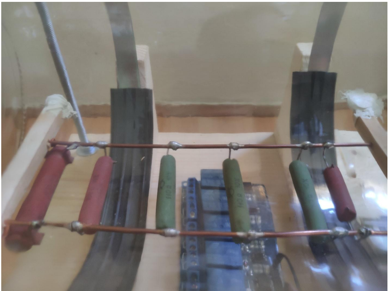
Slika 17. Grijači (žičani otpornici)
