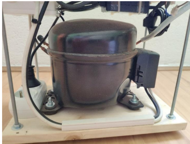
Slika 12. Vakuum crpka-kompresor, prednja strana
