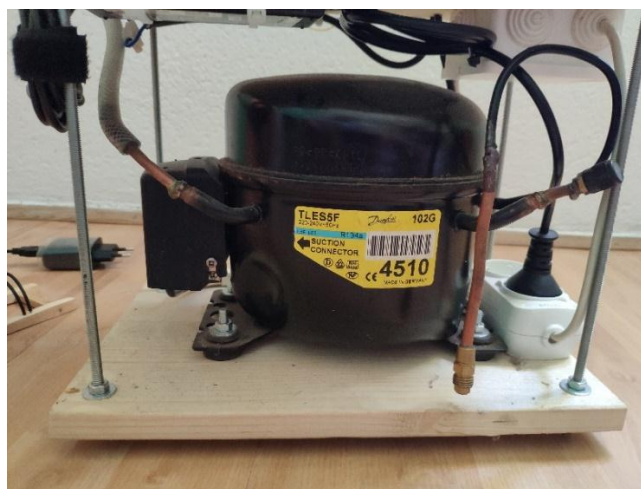
Slika 13. Vakuum crpka-kompresor, zadnja strana
