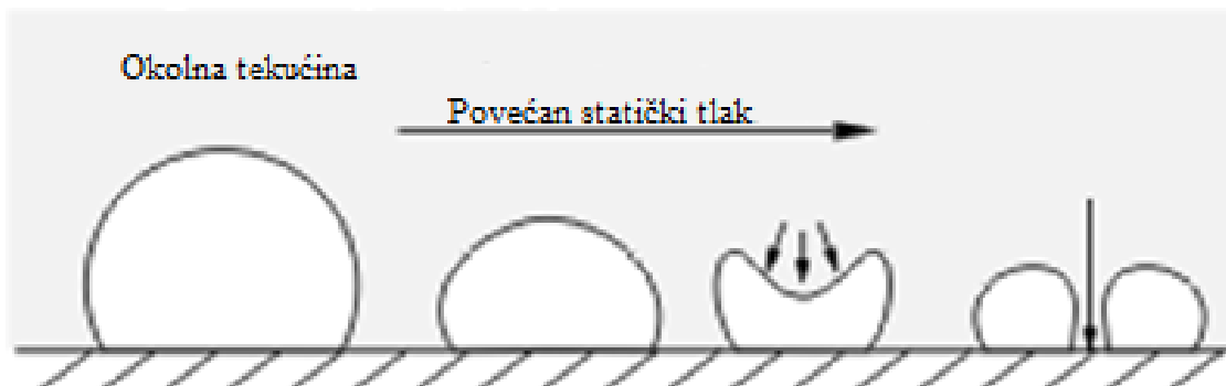
Slika 16. Shema kavitacijskog trošenja (Izvor: https://en.wikipedia.org/wiki/Cavitation#/media/File:Cavitation_bubble_implosion.png )
