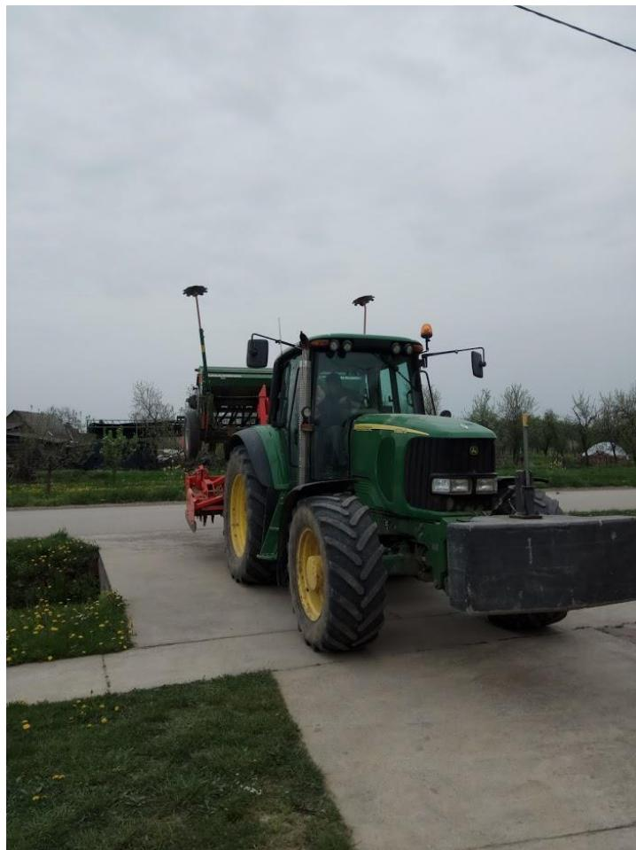
Slika 12. Sjetvena kombinacija sijačice i rotodrljače
