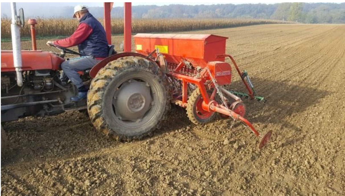
Slika 14. Sjetveni stroj u sjetvi ječma
