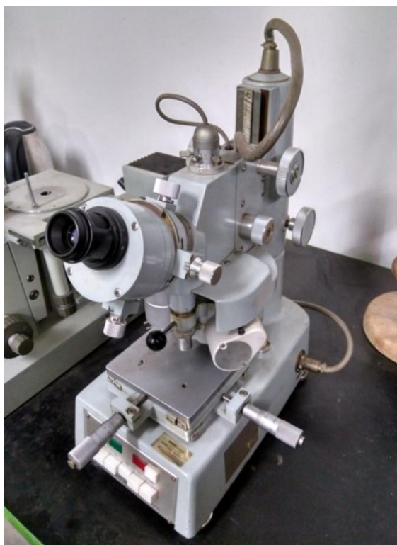
Slika 30. Mjerni mikroskop za mjerenje tvrdoće prema Vickers metodi (Izvor: autor)
