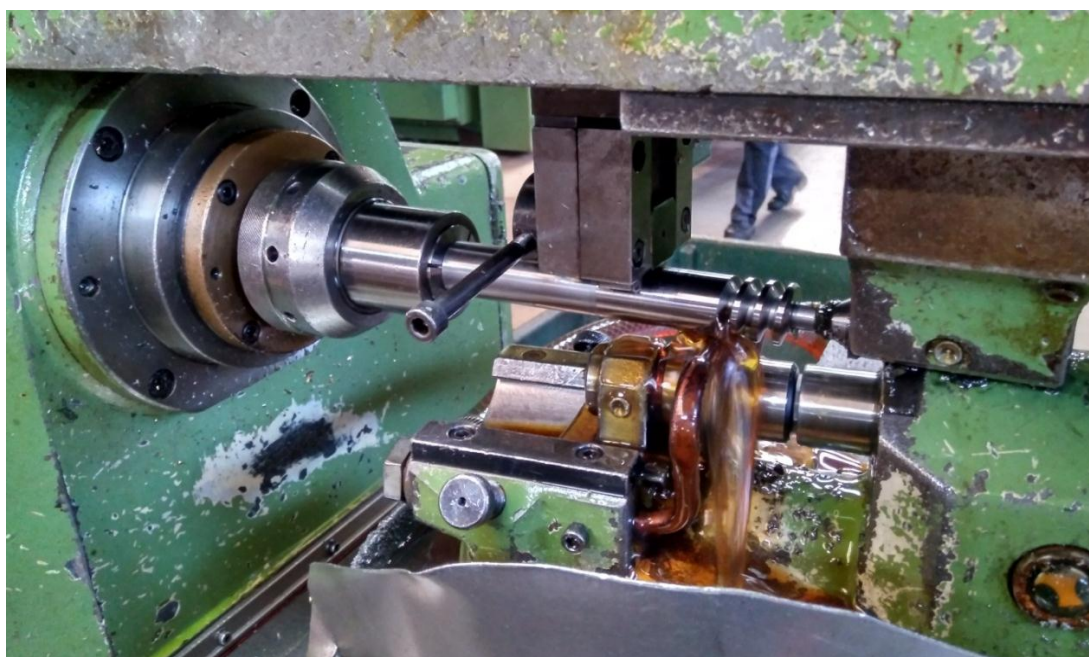
Slika 23. Izrada zavoja pužnog vratila na glodalici "Koeper 400". (Izvor: autor)
