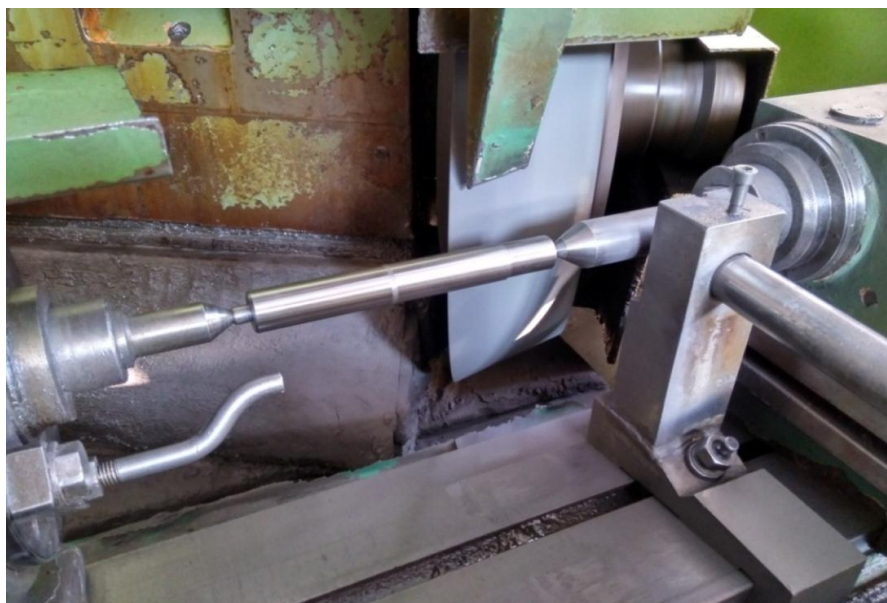
Slika 19. Brušenje tehnološke baze (Izvor: autor)
