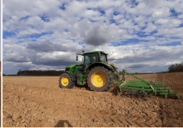
Slika 9. Predsjetvena obrada tla sjetvospremačem
