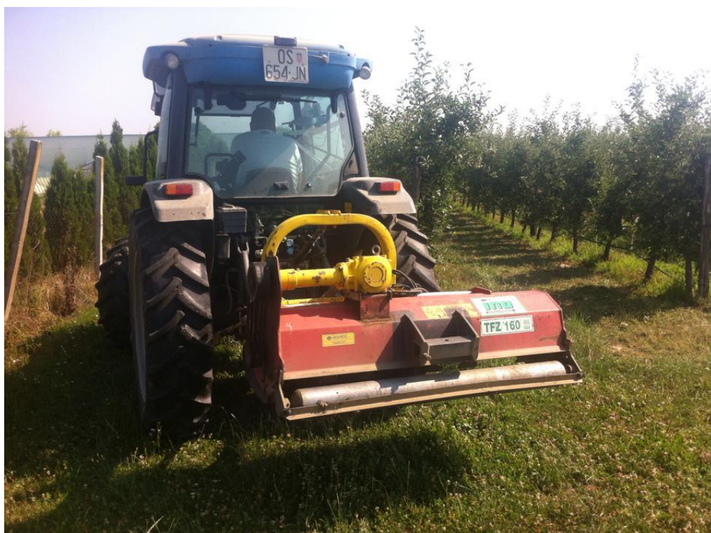
Slika 4. Mjerenje vibracija na trup rukovatelja, malčerm (vlastita fotografija)
