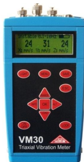
Slika 10. Uređaj za mjerenje vibracija MMF VM30-H (URL3)
