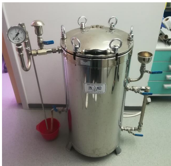
Slika 6. Autoklav – uređaj za sterilizaciju (Foto original: K. Orlović)
