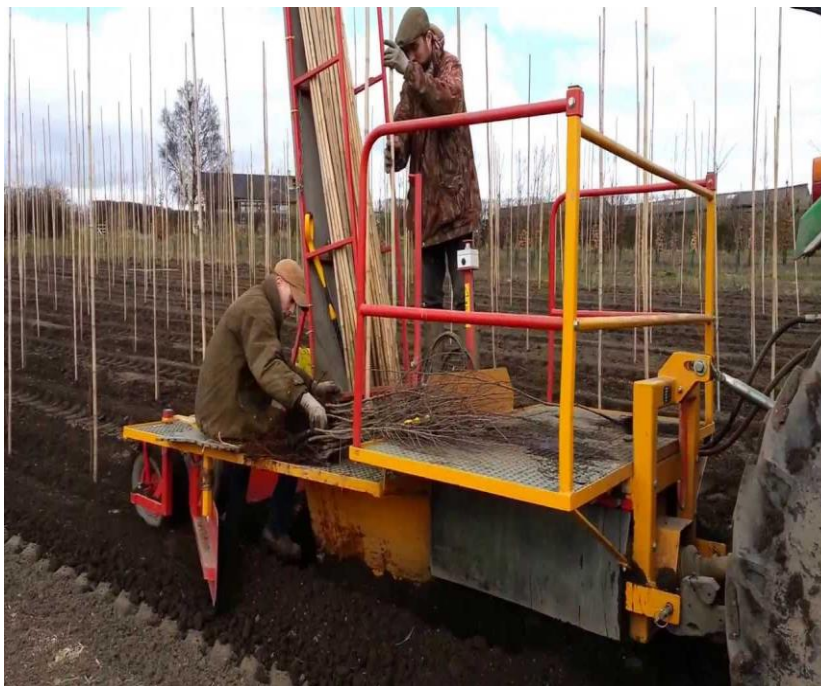
Slika 8. Sadilice sa ručnim ulaganjem sadnica (Izvor: www.youtube.com )
