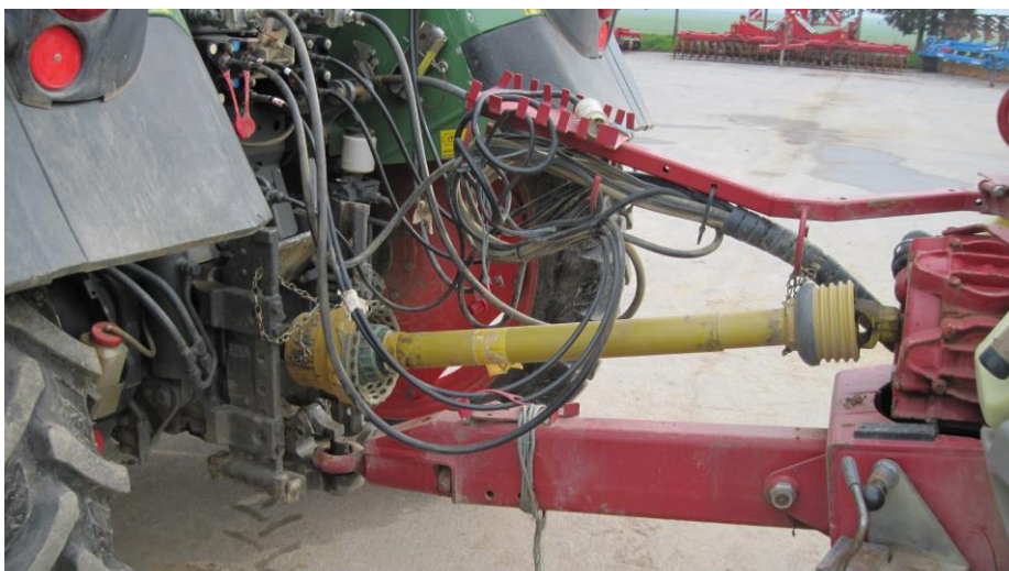
Slika 8. Pravilna zaštita PVT-a na prskalici Hardi Commander (Izvor: foto original M. Glavaš )
