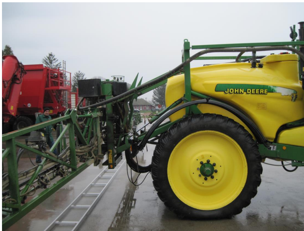
Slika 17. Testiranje površinske raspodjele tekućine na prskalici John Deere 3173 (Izvor: foto original M. Glavaš)
