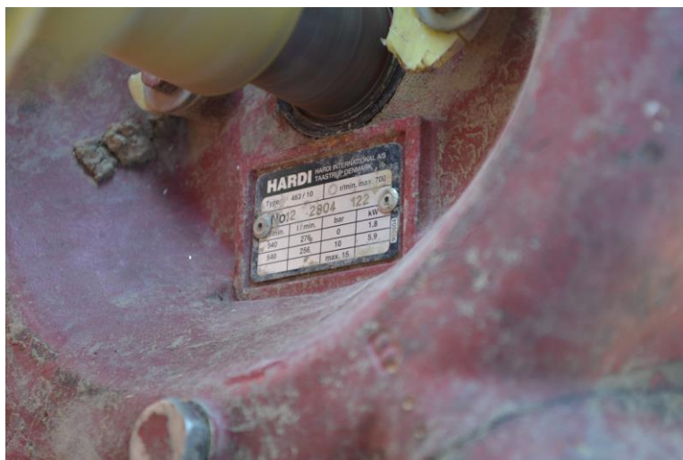
Slika 2. Tehničke karakteristike crpke tipa 463/10, serijskog broja 12 2804 122 (Izvor: foto original M.Glavaš)
