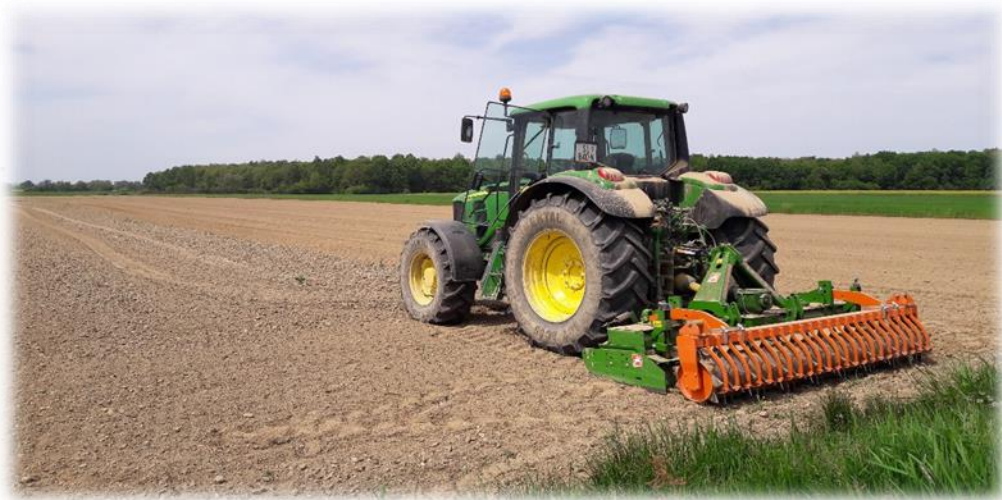
Slika 6. Rotacijska zvrk drljača
