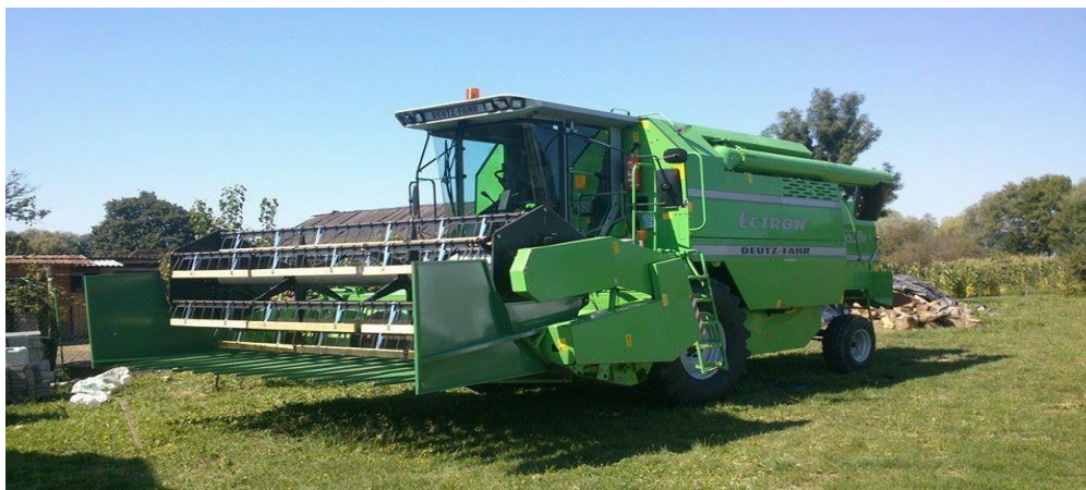
Slika 9. Kombajn s adapterom za suncokret
