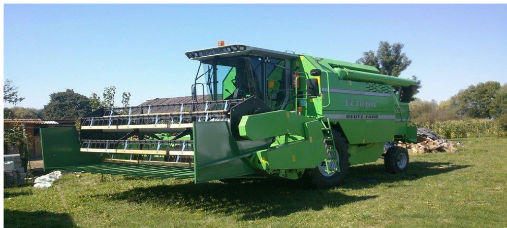
Slika 9. Kombajn s adapterom za suncokret
