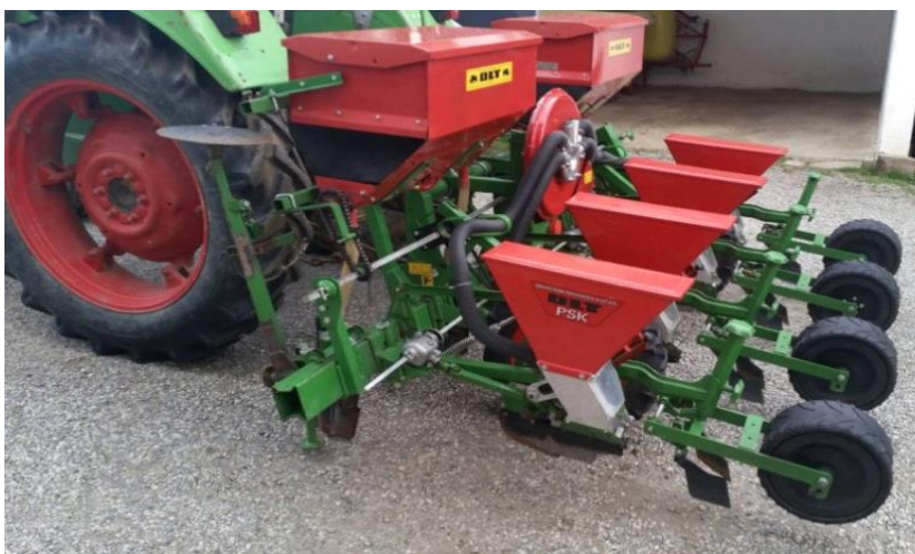
Slika 4. Pneumatska sijačica (Izvor: Banaj, 2016.)
