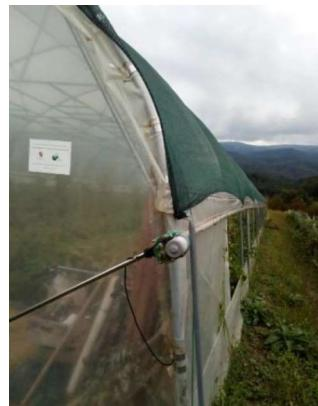
Slika 2. Elektromotor za automatsko podizanje i spuštanje bočnih strana plastenika
