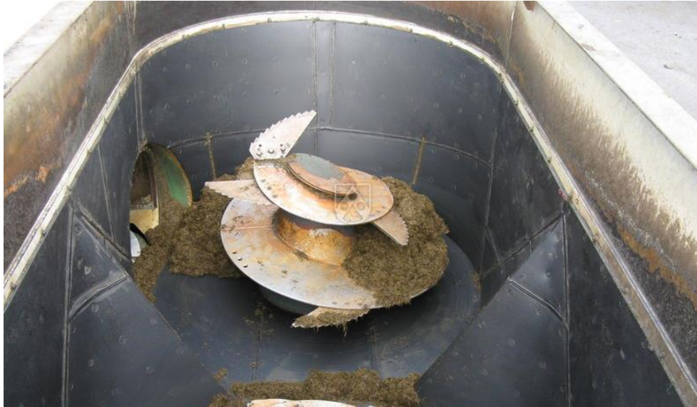
Slika 5. Prikaz korozivnog djelovanja na lopatice mješača
