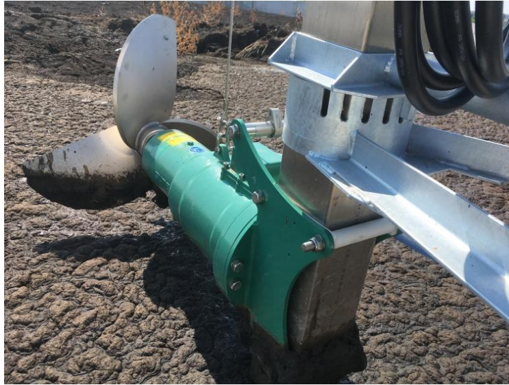
Slika 32. Korozivno djelovanje digestata na lopatice mješača
