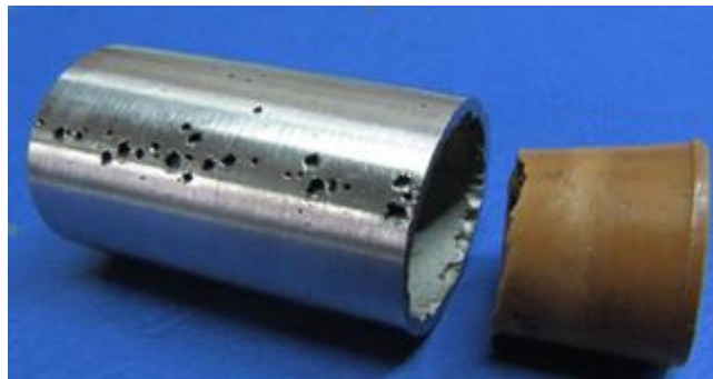
Slika 21. Korozija u procijepu
