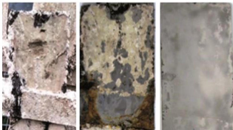
Slika 22. Uzorak 1.4509 2B nakon izloženosti tijekom 6 mjeseci u biodigestoru
