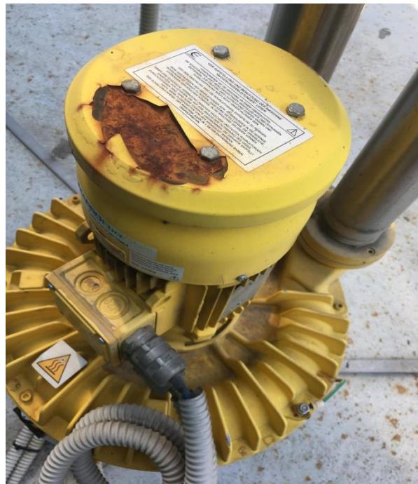
Slika 11. Površinska korozija elektromotora izloženog vanjskim utjecajima
