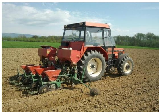
Slika 2. Sjetva soje pneumatskom sijačicom „OLT“ na OPG Stojaković
