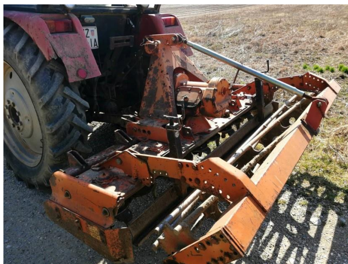
Slika 3. Zvrk drljača Landsberg 2,5 m (Izvor: autor)
