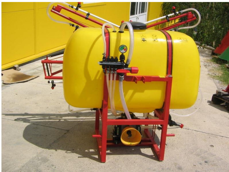
Slika 4. Prskalica MIO Standard TP 330 (Izvor: autor)
