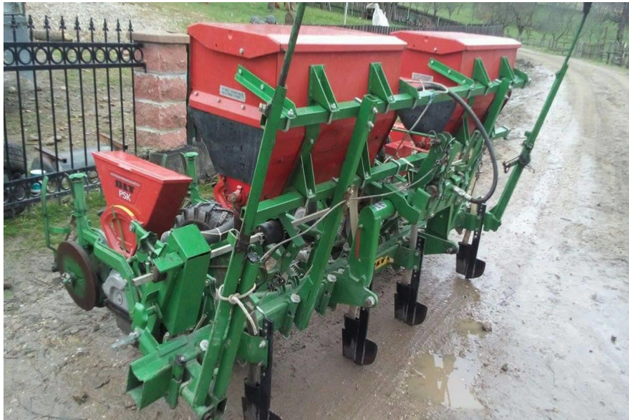
Slika 5. OLT psk sijačica 4 reda (Izvor: autor)
