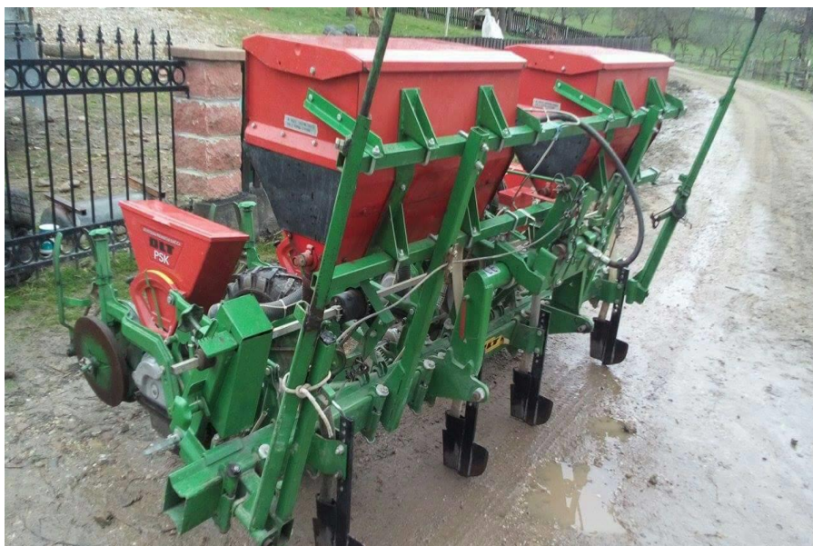
Slika 5. OLT psk sijačica 4 reda (Izvor: autor)
