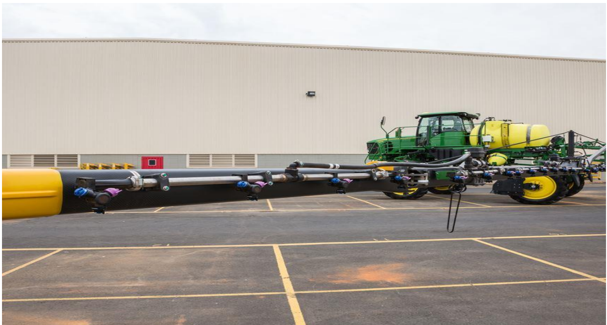
Slika 25. Grana traktorske prskalice – karbonska vlakna i epoxy
