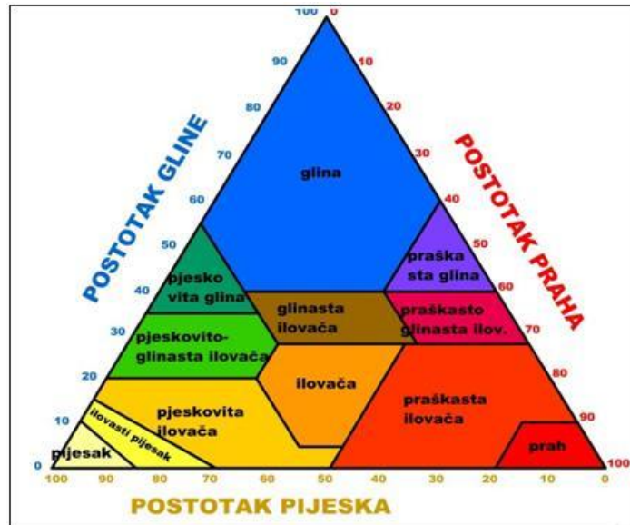
Slika 7. Teksturni trokut (Soil Survey Staff, 1951.)
