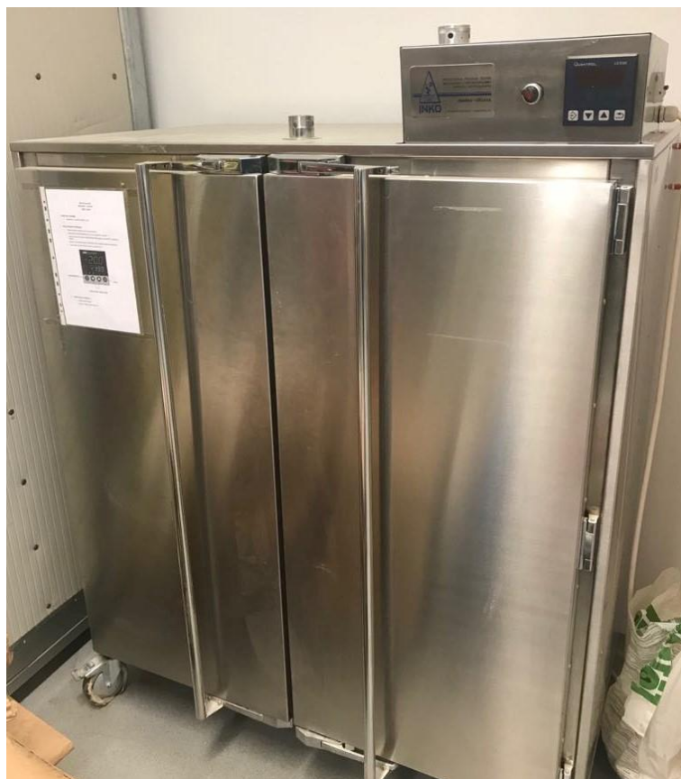
Slika 9. Sušionik Inkolab ST800
