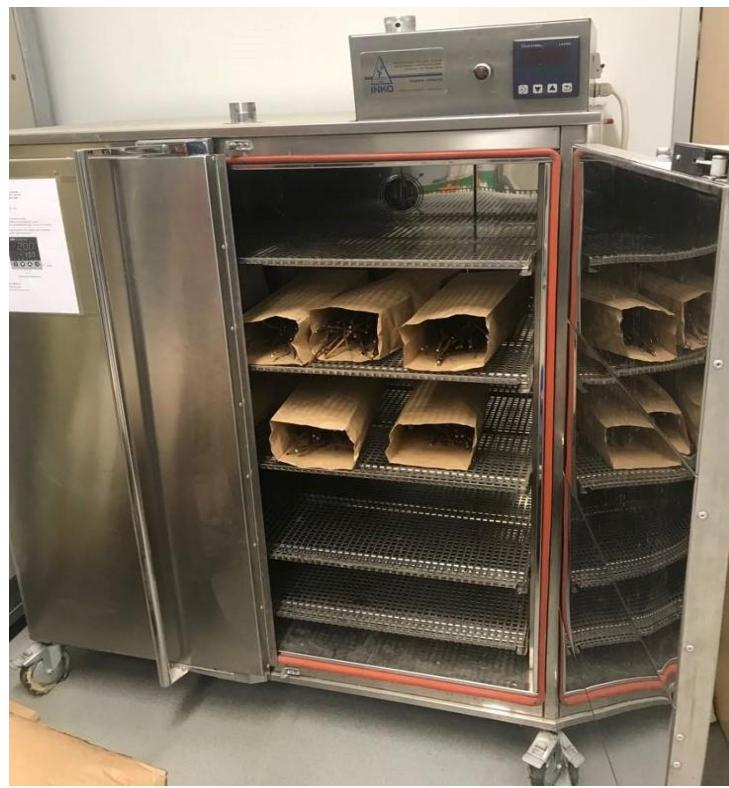
Slika 10. Uzorci pripremljeni sa sušenje u sušioniku
