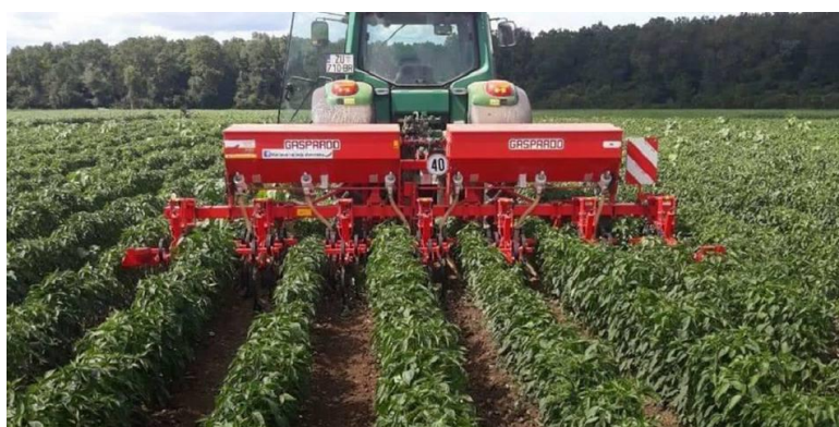
Slika 11. Kultivator Gaspardo HP 6 u radu, treća kultivacija i prihrana (Izvor: Vlastita fotografija)
