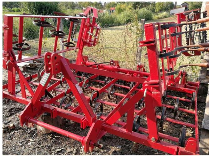
Slika 5. Sjetvo spremač proizvođača *Consum* radnog zahvata 3,6 m
