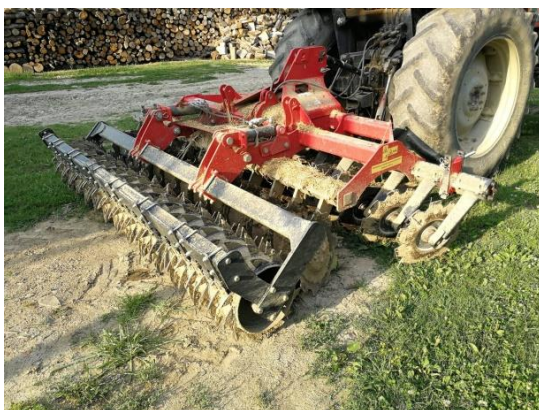
Slika 4. Kratka tanjurača proizvođača Metal – Fach radnog zahvata 3 m (Izvor: Vlastita fotografija)
