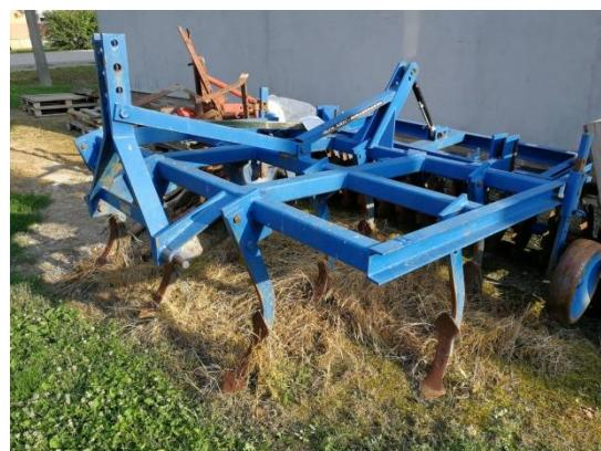
Slika 3. Podrivač proizvođača *Rabewerk* radnog zahvata 2,5 m
