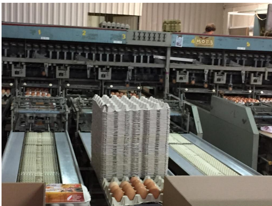
Slika 3. Izgled prostorije i uređaja za klasiranje i pakiranje jaja
