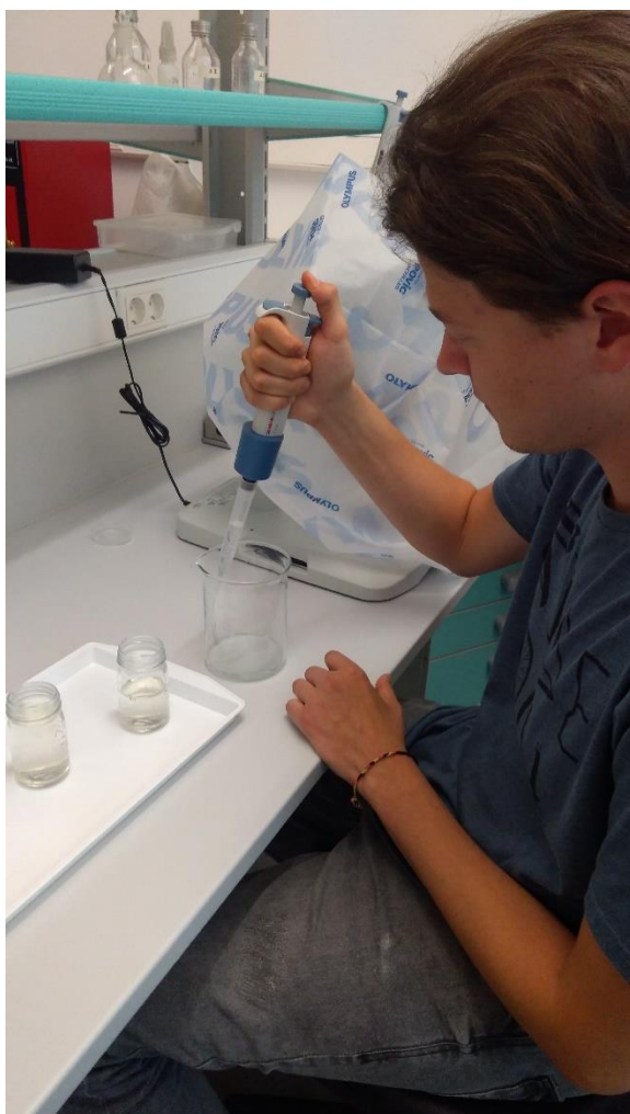
Slika 25. Izdvajanje viška vode pomoću pipete Foto: Poturiček L.
