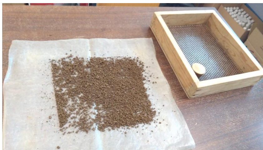
Slika 21. Usitnjavanje tla Foto: Poturiček L.
