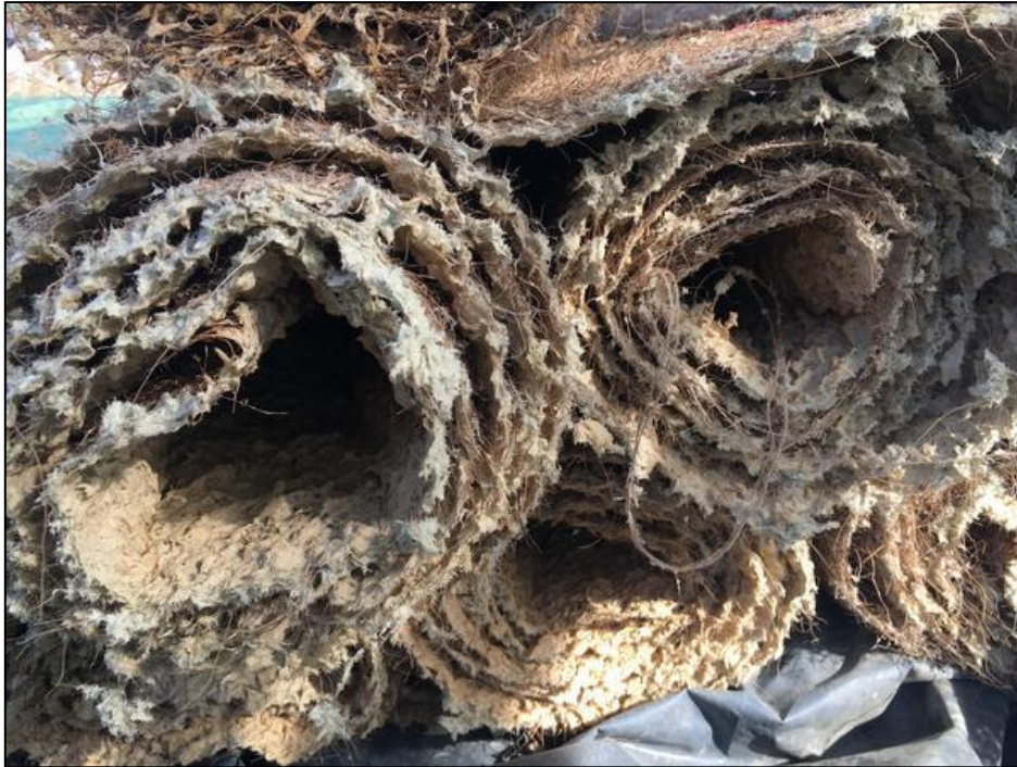
Slika 9. Izgled podloge trave prije postavljanja (izvor: https://www.floreo.hr )
