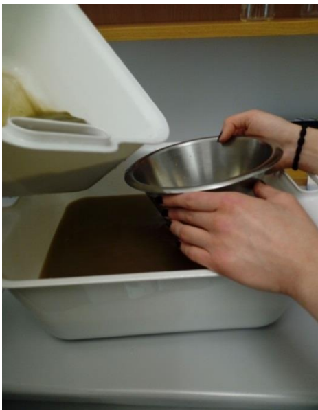
Slika 17. Pretakanje kroz sito od 365 \mu\text{m}
