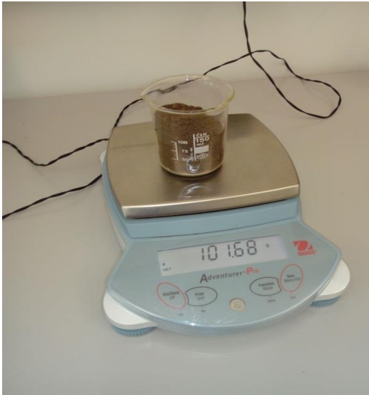
Slika 11. Vaganje 100 g uzorka tla
