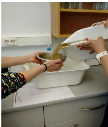
Slika 15. Sipanje suspenzije iz posude 1 u posudu 2
