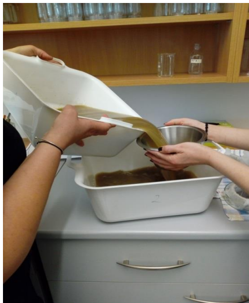
Slika 19. Pretakanje suspenzije kroz sito od 180 \mu m
