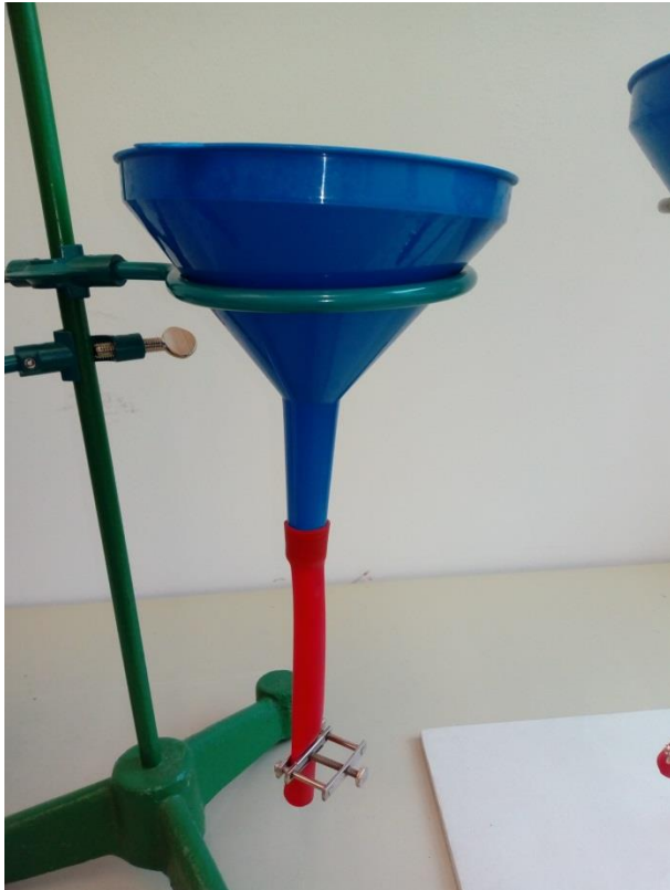
Slika 29. Pribor za metodu lijevka (Foto: L. Pavlic)
