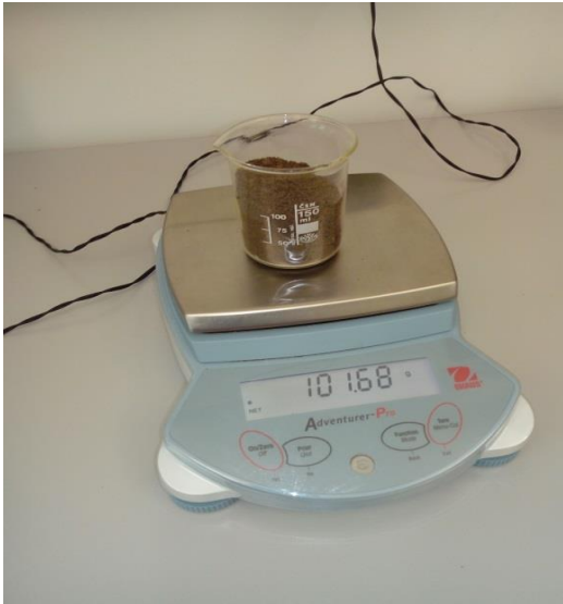
Slika 11. Vaganje 100 g uzorka tla
