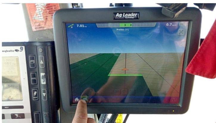
Slika 12. Prikaz prohoda traktora i rasipača na monitoru *Integra*
