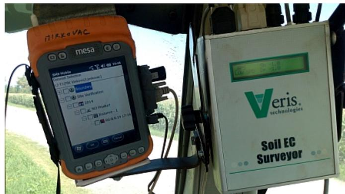
Slika 5. Oprema u traktoru za skeniranje elektrovodljivosti tla
