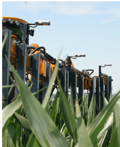
Slika 19. Skeniranje usjeva OptRx senzorom (Izvor: www.findri.hr )
