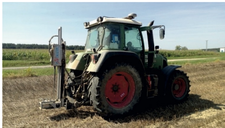
Slika 8. Uzimanje uzoraka tla sondom Nietfeld Duoprob
