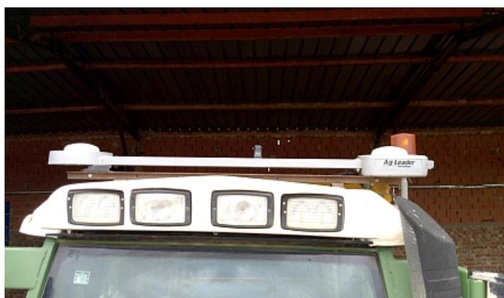
Slika 13. GPS antena postavljena na krovu traktora
