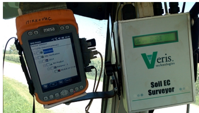
Slika 5. Oprema u traktoru za skeniranje elektrovodljivosti tla (Izvor: Stracenski, 2015.)
