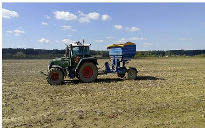
Slika 16. Precizna gnojidba rasipačem *Bogballe* M3W pogonjen traktorom *Fendt* 412
