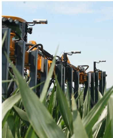
Slika 19. Skeniranje usjeva *OptRx* senzorom
