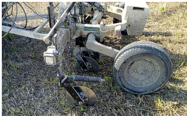
Slika 4. Skener elektrovodljivosti tla Veris EC Surveyor 3150 (Izvor: Barač i sur., 2016.)
