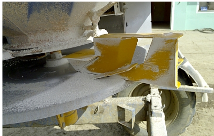
Slika 14. Lopatica za MAP na rasipaču Bogballe M3W (Izvor: Stracenski, 2015.)
