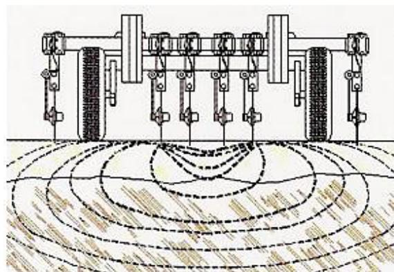
Slika 3. Sustav mjerenja elektrovodljivosti tla kontaktnim sensorima
