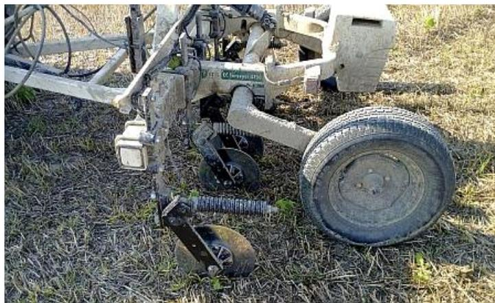
Slika 4. Skener elektrovodljivosti tla *Veris EC Surveyor 3150*
