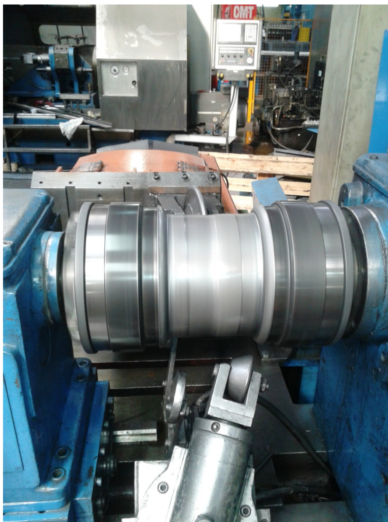
Slika 22. Oblikovanje profila i ramena naplatka (autor)
