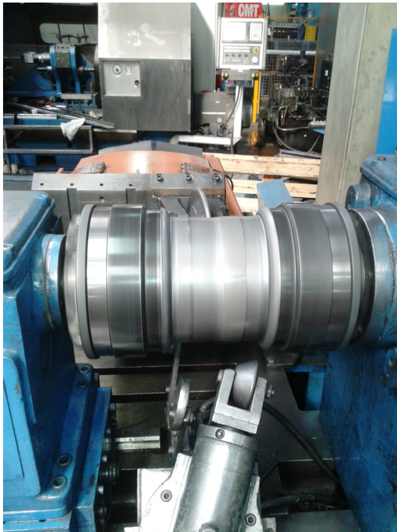
Slika 22. Oblikovanje profila i ramena naplatka (autor)
