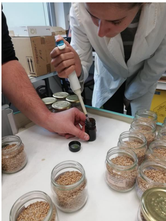
Slika 17. Primjena ekstrakta Kartell mikropipetom (Izvor: P. Lucić)
