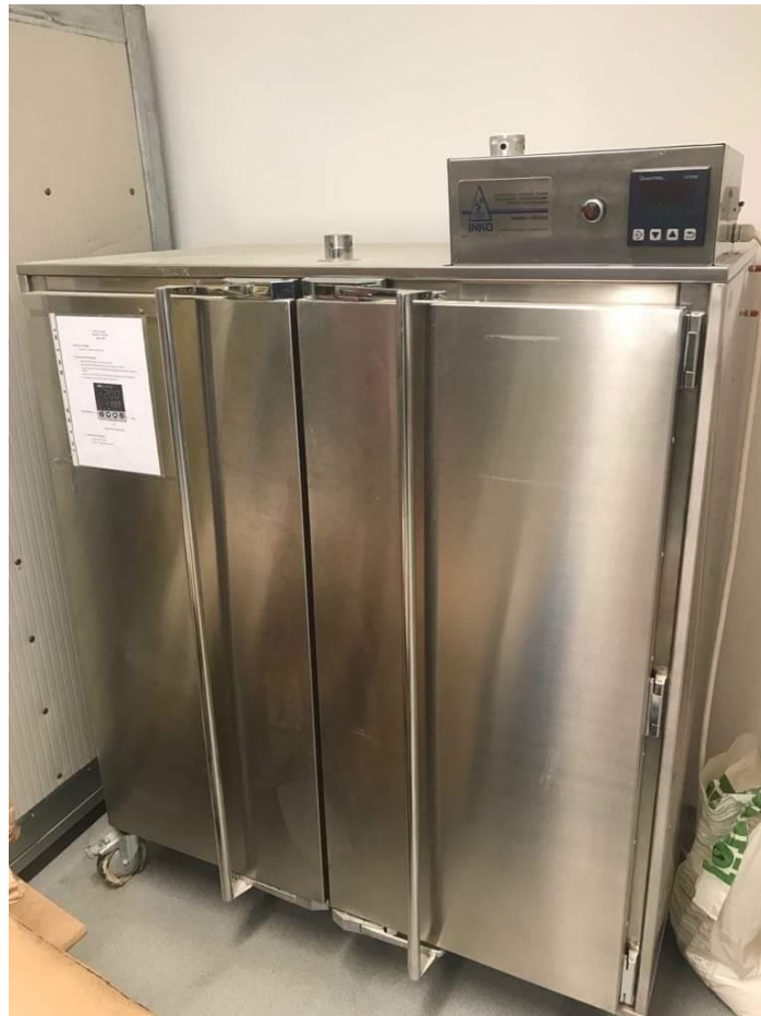
Slika 8. Sušionik (ST 800 T, 5000 W)
