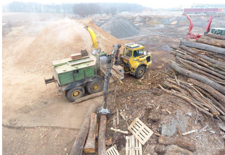
Slika 17. Drobilica za drvo - iverać
