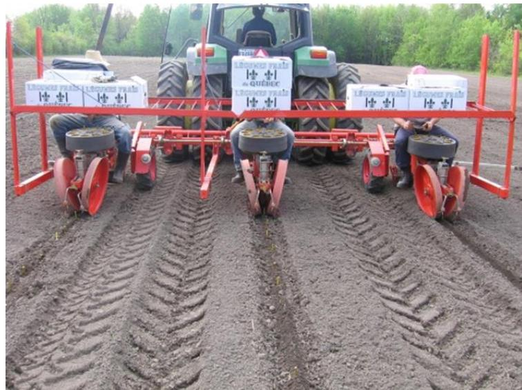
Slika 11. Stroj kojim se sadnja rezница odvija odjednom u tri reda
