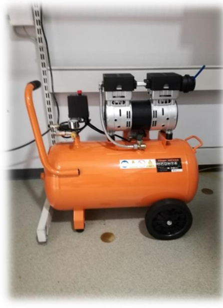
Slika 21. Pneumatska jedinica (kompresor), (Foto: Milaković, 2019.)
