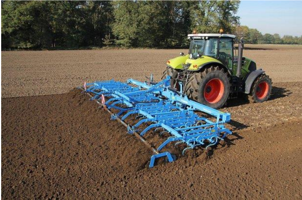
Slika 5. Obrada tla sjetvospremačem (Izvor: http://www.profiland.hr/en/products/item/61-obrada-tla )
