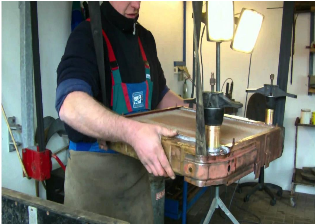
Slika 29. Provjera nepropusnosti zalemljenih spojeva na hladnjaku (Izvor: https://i.ytimg.com/vi/nab0_MgH9cM/maxresdefault.jpg )
