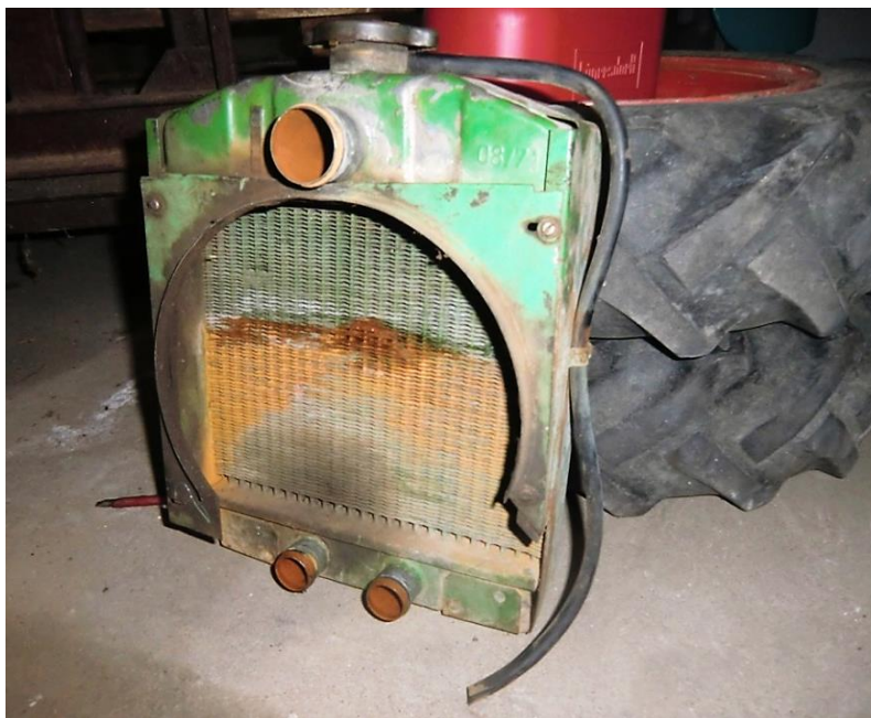
Slika 24. Primjer oštećenog hladnjaka traktora
