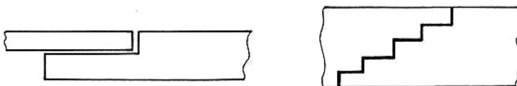
Slika 9. Postupni spoj (Izvor: Garašić, 2012.)
