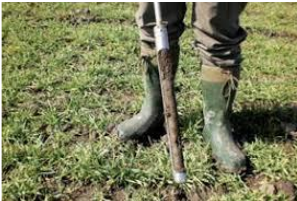
Slika 2. Uzimanje uzoraka cilindričnom sondom 0-30 cm
