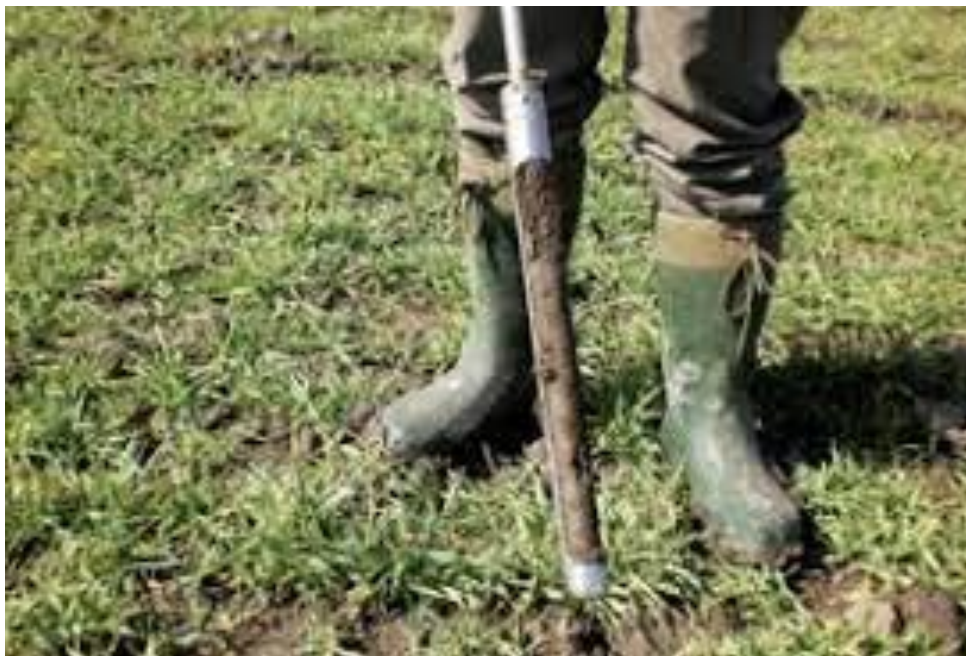
Slika 2. Uzimanje uzoraka cilindričnom sondom 0-30 cm
