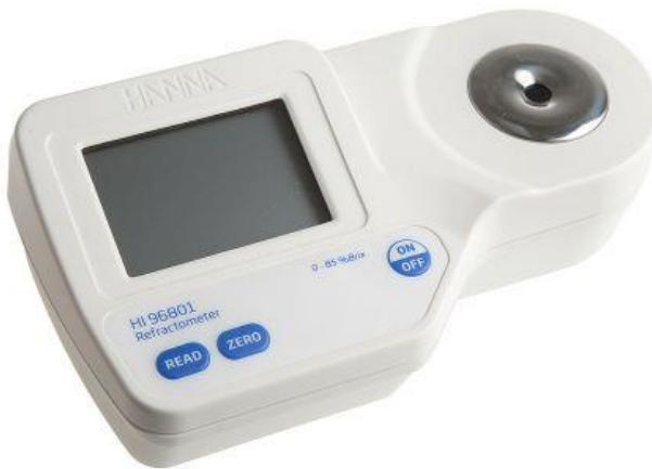
Slika 8. Brix refraktometar HI 96801
