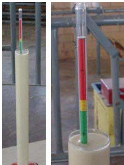
Slika 4. Kolostrometar
