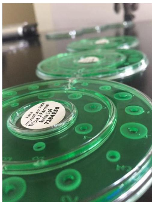
Slika 7. IgG kit test radijalne imunodifuzije
